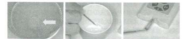
咀嚼したグミゼリーを、メッシュをセットしたコップに吐き出す 唾液をブラシで採取 咀嚼能力検査システムでグルコース溶出量を計測
