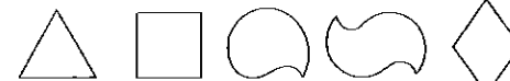
リーマーの断面は正三角形である。Kファイルの刃部の断面は正方形であるが、三角形のものもある。
